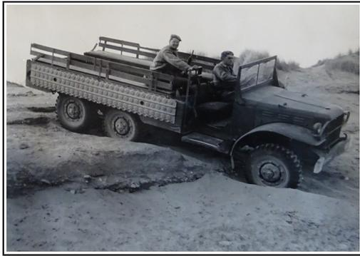
C'est « mon » camion. Un *Dodge* à 3 essieux et donc moins inconfortable pour les hommes que je transporte, que ceux à 4 essieux. Il est très robuste, très maniable. Un des risques, c'est l'enlèvement, d'où l'équipement facilement détachable sur les flancs du véhicule.
